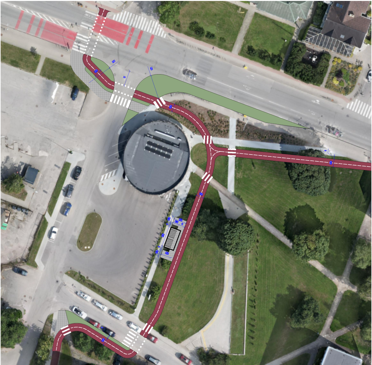
149 pav. Sprendimo rekomendacija dviračių takų jungčiai tarp Melioratorių takų ir Klaipėdos g. pro autobusų stotį. Schema mmap.
