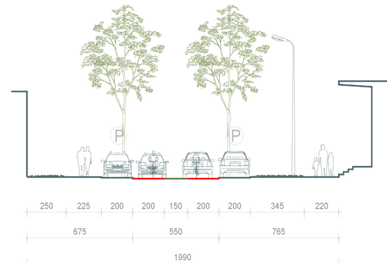
143 pav. Vasario 16-osios g. tarp Klaipėdos g. ir Gargždų „Minijos“ progimnazijos sprendimo rekomendacijų pjūvis. Schema mmap.
