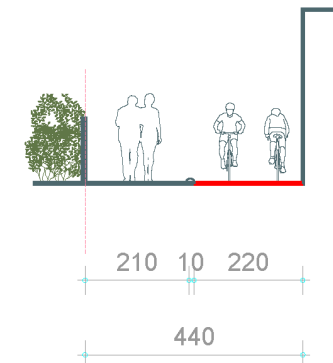
107 pav. Vingio g. tarp Smėlio g. ir Melioratorių tako nebrangaus sprendimo rekomendacijų pjūvis. Schema mmap.
