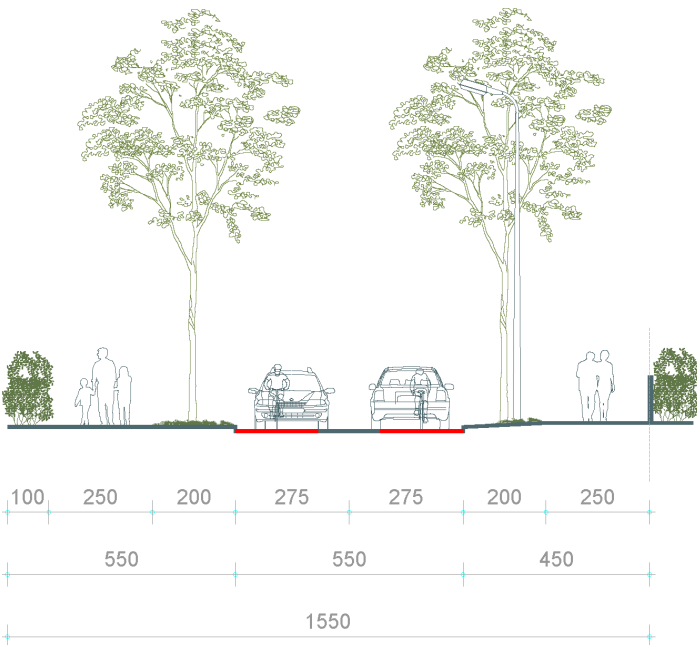
116 pav. Vingio g. tarp Pušų g. ir Kuršlaukio g. sprendimo rekomendacijų pjūvis. Schema mmap.
