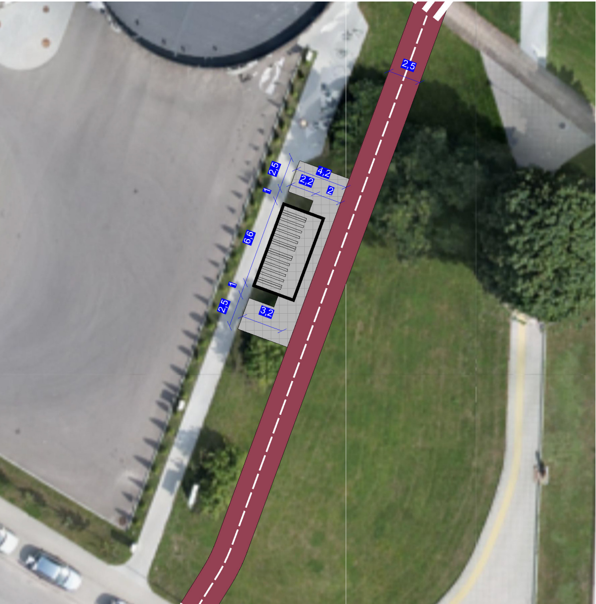
152 pav. Dviračių saugyklos prie autobusų stoties A scenarijaus vieta ir matmenys. Schema mmap.
