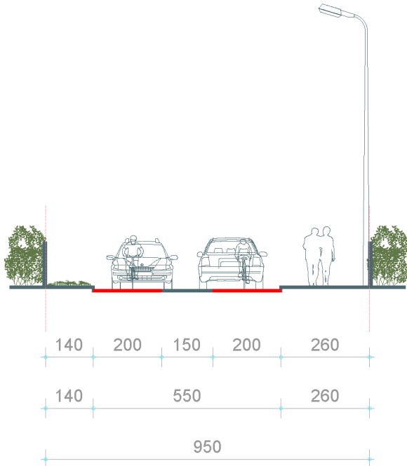
114 pav. Vingio g. tarp Butkų Juzės g. ir Gėlių g. sprendimo rekomendacijų pjūvis. Schema mmap.
