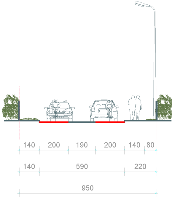
113 pav. Vingio g. tarp Butkų Juzės g. ir Gėlių g. nebrangaus sprendimo rekomendacijų pjūvis. Schema mmap.
