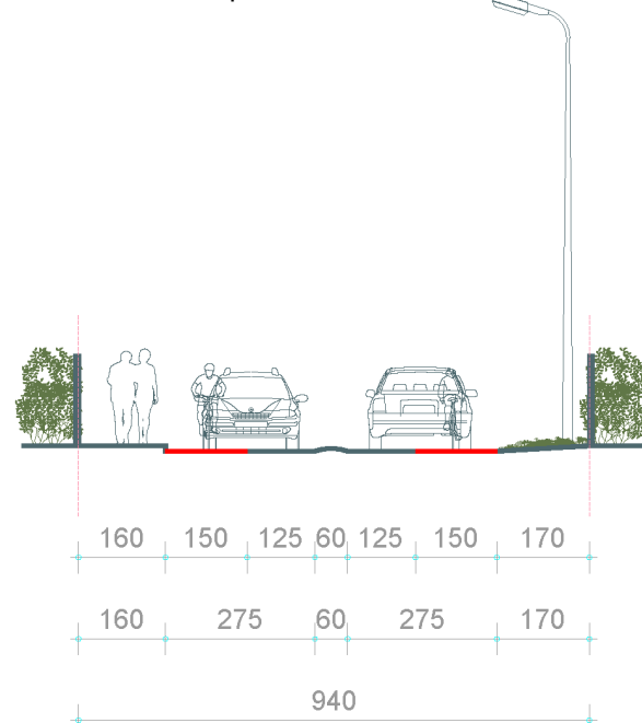
99 pav. J. Basanavičiaus g. tarp Pomidorų tak. ir Kulių nebrangaus sprendimo rekomendacijų pjūvis. Schema mmap.
